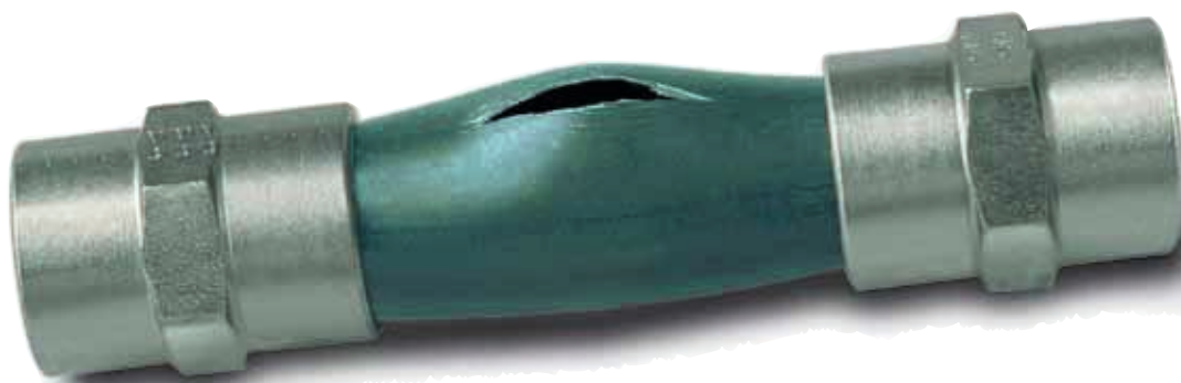
Разрушающий тест на трубе 22x2 из углеродистой стали. Труба разрывается при 800 атм. без каких-либо протечек или конденсации из точек уплотнения.
