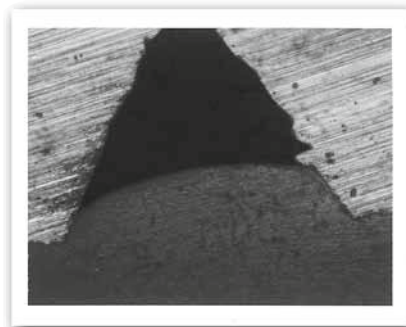
ТОЧКА УПЛОТНЕНИЯ 6 УПЛОТНЕНИЕ ПЛОСКОЙ ШАЙБЫ В РЕЗЬБЕ ГАЙКИ
